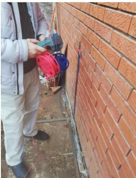
Рис.2. Испытание заземления.
