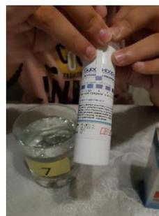
Рис.9. Результат исследования жёсткости воды образца №7
