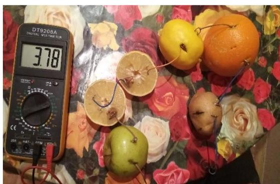
В данном опыте соединили последовательно между собой несколько фруктов или овощей и мультиметр с помощью оцинкованного шурупа, медной проволоки и проводов. Измерили напряжение с помощью мультиметра.
