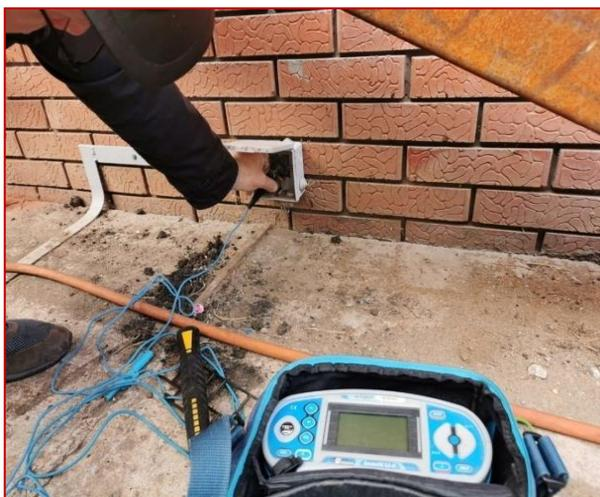
Рис.3. Испытание заземления через год
